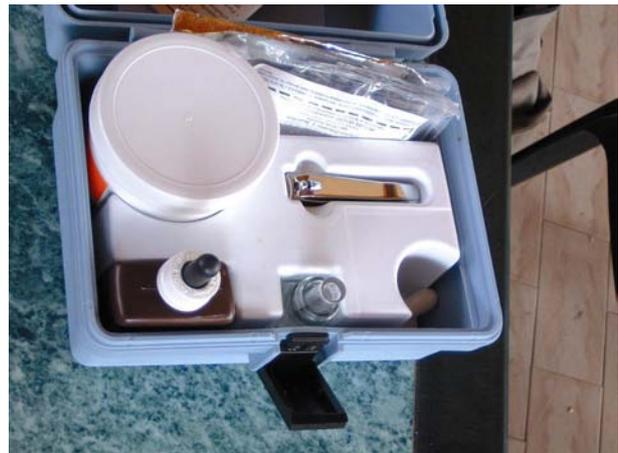
*Il kit da campo per il rilevamento dell'ossigeno disciolto*
